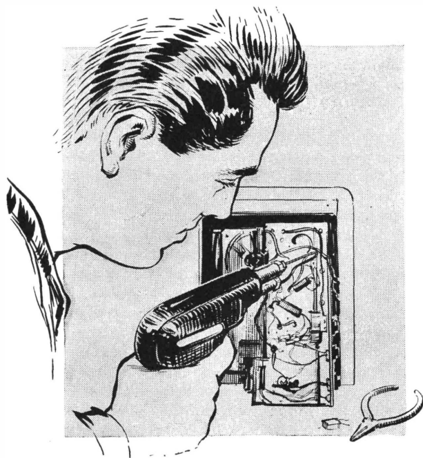
Fig. 17.13. - Esempio di saldatura con saldatore a trasformatore.
