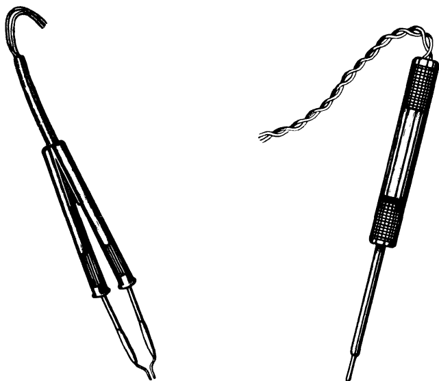
Fig. 17.9. - Due tipi di saldatori adatti per apparecchi a transistor.
