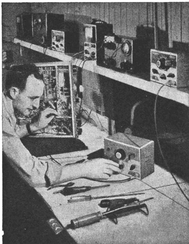
Fig. 7.3. - Tipico tavolo di prova attrezzato per l'allineamento di apparecchi radio.
